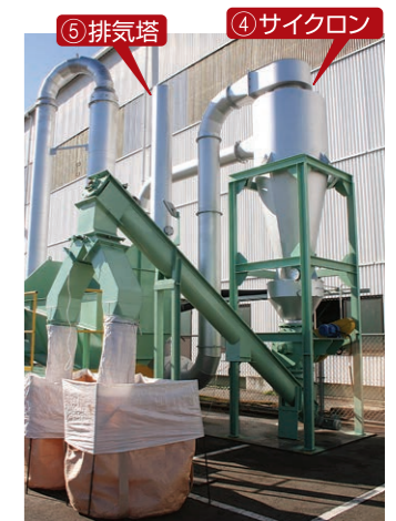
④ サイクロン サイクロンにて水蒸気混じりの排気ガスと乾燥品とを分離します
