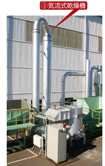
③ 乾燥機本体 引火・乾燥むらを完全に防止する特殊構造の上昇管と下降管とを熱風で空気輸送する間に被乾燥物の含有する水分を蒸発させます
