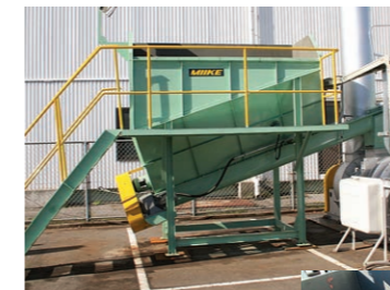
① 原料定量供給機 定量供給機からオガ粉・木粉・粉粒体(被乾燥物)を定量的に供給します
