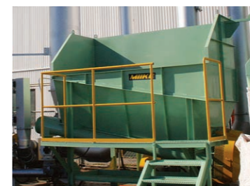
⑥ 燃料定量供給機 ウッドチップ・オガ粉、各々を水分20%以下で投入
