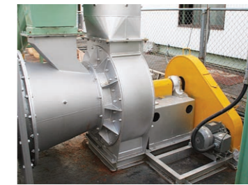
② 解砕機 オガ粉・木粉・粉粒体(被乾燥物)は解砕機で一粒一粒バラバラにして、効率良く熱風と接触して熱交換させます
