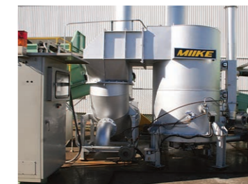
⑦ バイオマスバーナー ウッドチップ・オガ粉・その他、さまざまなバイオマスを燃料としてマルチバイオマスバーナーで熱風を発生させます
