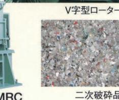
15mm程度のサイズに破碎します。MIIKEの“MRCシリーズ”は、安定した効率の高い破碎ができます。(詳細は“MRCシリーズ”のカタログをご覧ください)
