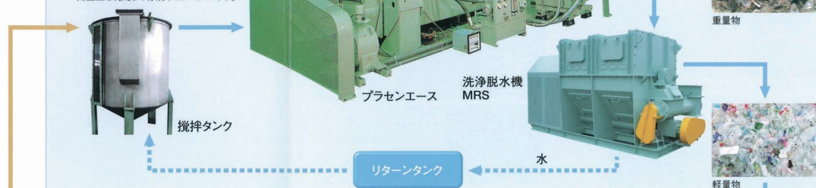
比重1.0以下のプラスチック(以下、軽プラ)排出側に含まれる、比重1.0以上のプラスチック(以下、重プラ)の混入率、および重プラ排出側に含まれる軽プラの混入率は1%以下という高精度の分級が可能です。元のペール品の性状にもよりますが、乾燥重量比で軽プラ:重プラ=5:5~7:3程度に分別します。また、軽プラの塩素濃度は概ね0.1%以下になります。他社同等品と比較して、歩留まりが非常に良いことが特徴です。
