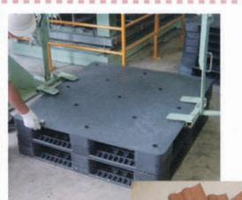
成形機により樹脂ペレット・花壇・通い箱など、さまざまな成形製品に成形されます。MIIKEのマテリアルリサイクルプラントでは、造粒工程で半熔融ペレットを採用しており、完全熔融ペレットほど熱がかかっていないため、製品の強度が高くなるという利点があります。
