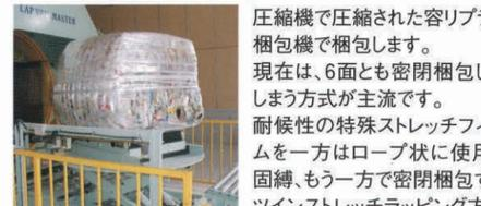
圧縮機で圧縮された容リプラを梱包機で梱包します。現在は、6面とも密閉梱包してしまう方式が主流です。耐候性の特殊ストレッチフィルムを一方はロープ状に使用し固縛、もう一方で密閉梱包するツイinstレッチラッピング方式です。
