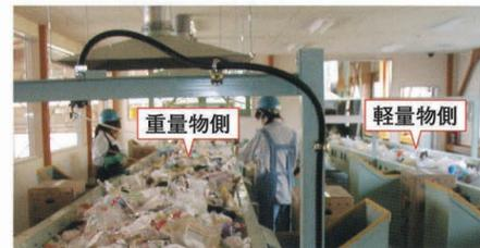
軽量物には異物はほとんど入っていません。逆にその分重量物には異物が多く含まれてくるので、重量物側だけ手選別をする、もしくは重量物側により多くの作業員を配置する、というように作業の効率化が図れます。
